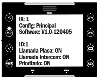
El menú "Info Sistema" es meramente informativo. Muestra la configuración del dip-switch y los interruptores que hay en la parte trasera del monitor.
