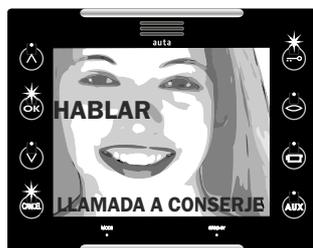
En caso de existir una central de conserjería, se podrá establecer una comunicación de audio con la misma desde el monitor, con una duración máxima de 1m 30s. Para realizar esta función pulse OK para activar el monitor y seguidamente el botón abre-puertas ( ).
