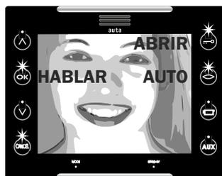
Se puede activar el video del monitor con cualquier placa o cámara inteligente de la instalación que le haya llamado alguna vez pulsando ( ). Se puede hacer incluso en el estado de conversación.
