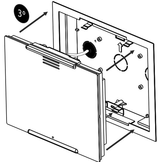
**NOTA:** Si al colocar el monitor nota que no está firmemente sujeto, doble ligeramente las fijaciones de la plancha para aumentar el agarre.
