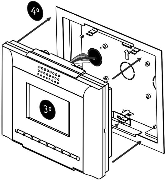
**NOTA:** Si al colocar el monitor nota que no está firmemente sujeto, doble ligeramente las fijaciones de la plancha para aumentar el agarre.
