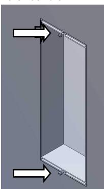
Coloque el muelle de abatimiento de placa en la caja de empotrar, y a continuación enganche la placa de calle presionando el muelle tal y como se indica en la figura.
