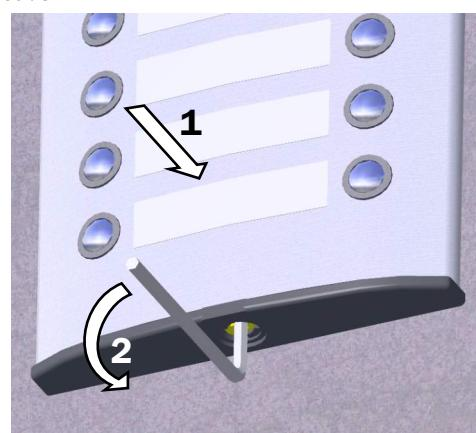
Gire la llave allen tal y como se indica en el dibujo hasta que la cabeza del tornillo entre dentro del cabezal de la placa.
