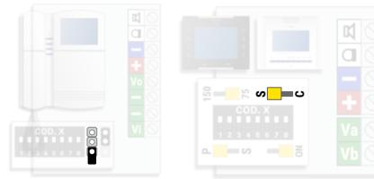
EN SISTEMAS CON DISTRIBUCIÓN EN CASCADA COLOCAR EL JUMPER DE CARGA EN TODOS LOS MONITORES DE LA MISMA LÍNEA "QUITADO" "S" EXCEPTO EN EL ÚLTIMO
