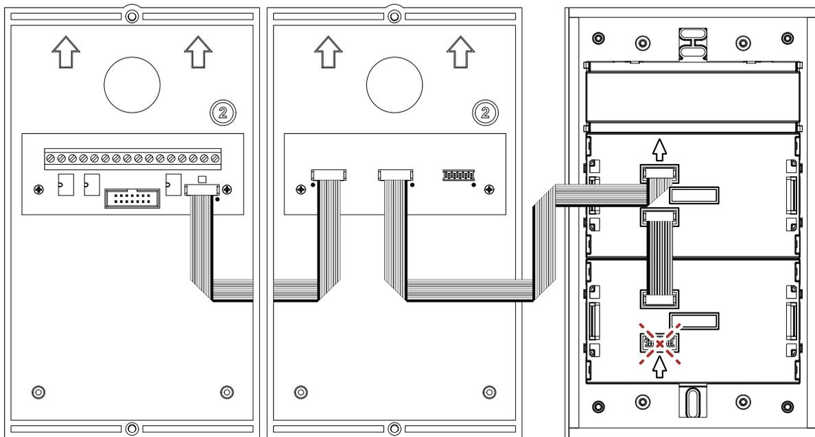
La conexión de la placa al módulo multi-placa se realizará siempre usando el conector libre SUPERIOR del conjunto de módulos.
