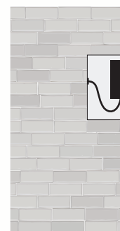
Cerrar la placa realizando una curva inferior con el cableado Connect the panel doing a lower curve with the wiring
