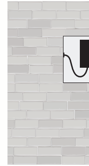
Cerrar la placa realizando una curva inferior con el cableado Connect the panel doing a lower curve with the wiring
