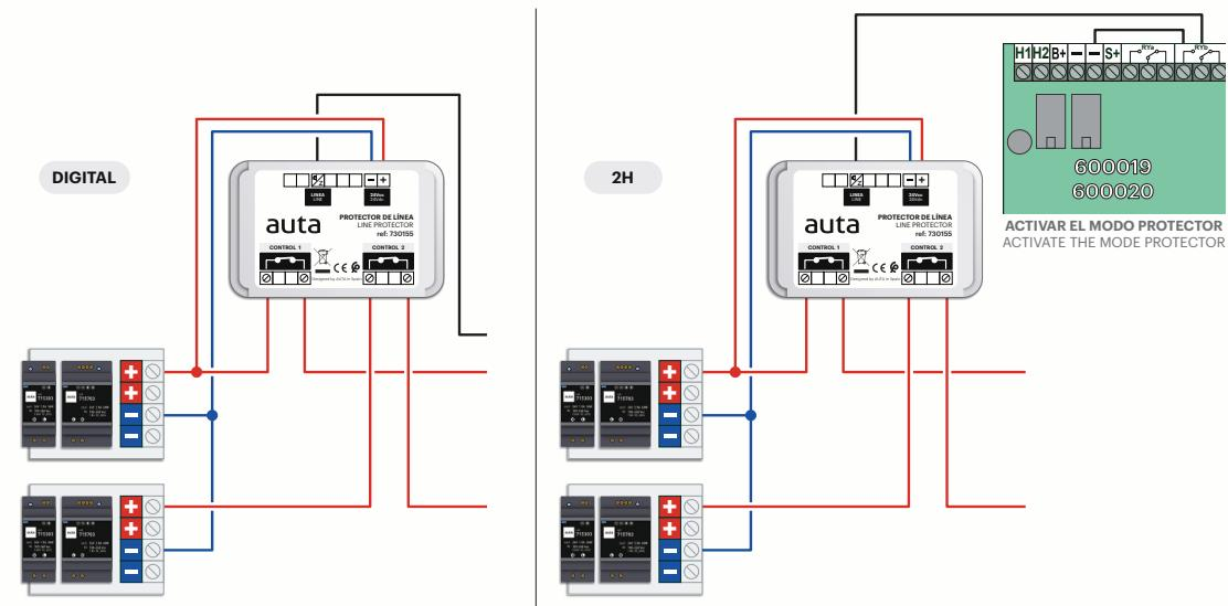
\* En instalaciones con un única fuente se usará solamente una de las dos salidas de control
